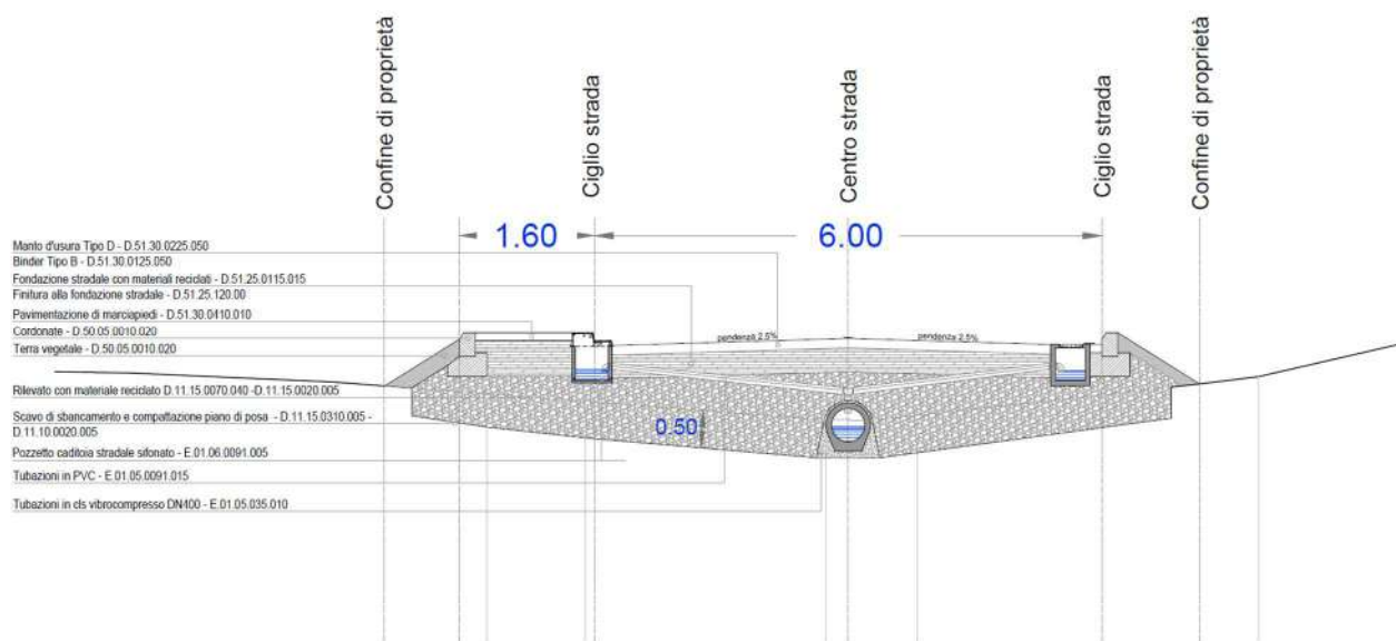
Fig. 1.6- Sezione tipo della nuova bretella
